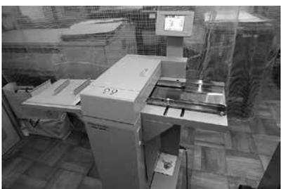
導入したホリゾン製筋押し機
